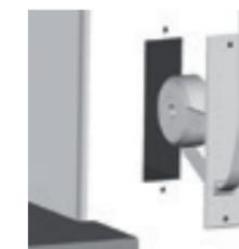
2. Smontare il vecchio avvolgitore nel caso in cui si intenda rinnovare un impianto per tapparelle già esistente.
