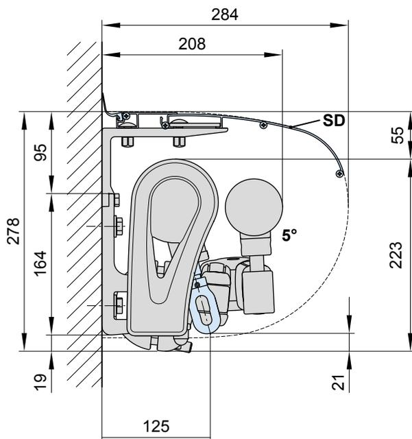
12 Fissaggio a soffitto, azionamento con asta di manovra
