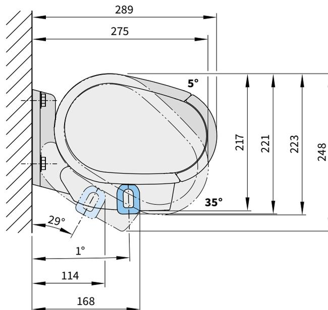
**Attenzione!** In caso di montaggio a parete della markilux 6000 con motore radiocomandato e manovra di soccorso, l'inclinazione massima della tenda è di 35°!
