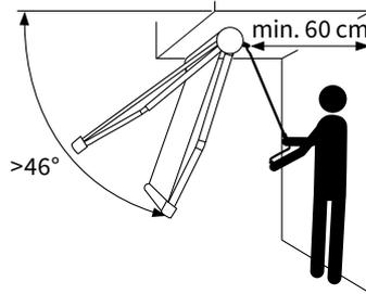
In caso di motore con manovra di soccorso e tenda inclinata oltre 46° rispetto al piano, bisogna prevedere uno spazio percorribile di almeno 60 cm nella parte posteriore, per poter utilizzare agevolmente il comando manuale
