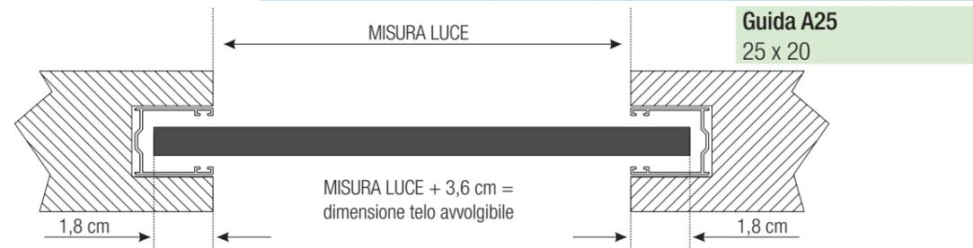
**Rilievo misure in luce larghezza con guide A 25**
