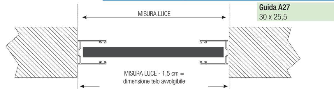
**Rilievo misure in larghezza con guide esistenti**
