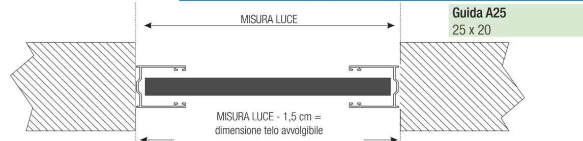
**Rilievo misure in larghezza con guide A 27**
