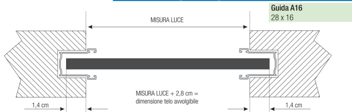
**Rilievo misure in larghezza con guide A 28**
