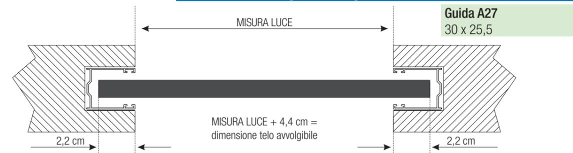
**Rilievo misure in luce larghezza con guide A 27**
